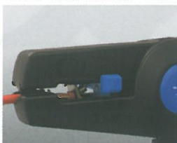
8~12mmの長さでストリップの長さを調整可能です。
