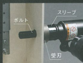
ボルトにスリーブ・受刃を付けて 下穴に差し込み
