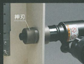
ボルトに押刃を付けて
