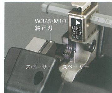
W3/8・M10切断時はスペースを使って刃を固定
