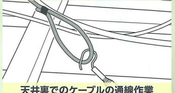
天井裏でのケーブルの通線作業
